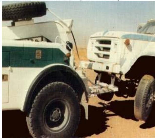
1.3-сурет- Көтеру жабдықтармен жабдықталған ақаулы көліктер арнайы тартып эвакуациялау, қысқыш және құлыптау құрылғылар
