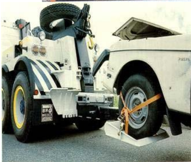
1.3-сурет- Көтеру жабдықтармен жабдықталған ақаулы көліктер арнайы тартып эвакуациялау, қысқыш және құлыптау құрылғылар
