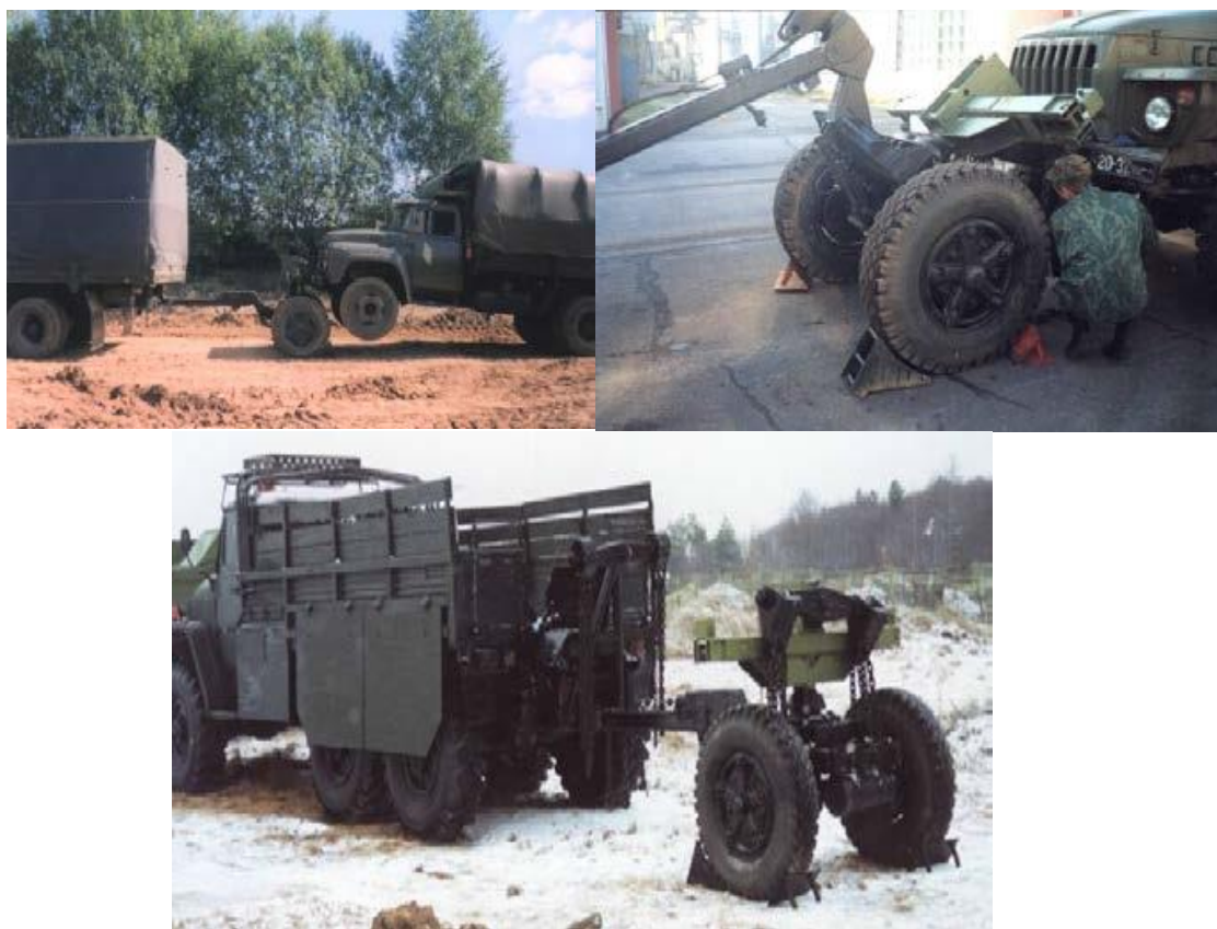
1.7- сурет -Трактор -тіркемені сүйреуге автокөліктің фаркоп тік тартым күші жиналмалы мүмкіндігімен ақауы бар автокөлікті тиеу қамтамасыз етіледі
